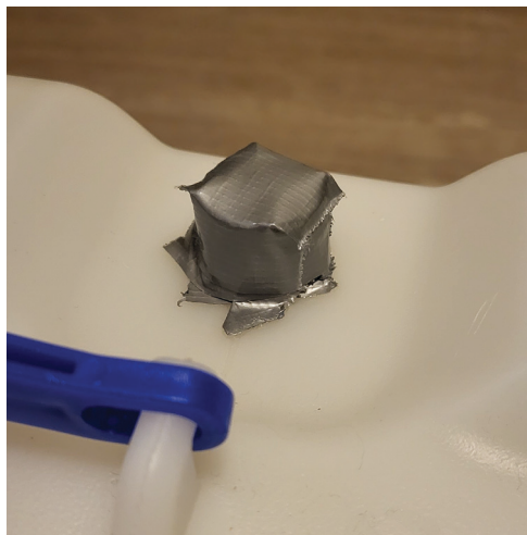
(d) Patenttia vaille valmis viritys vesiasian ilmauskorkin tilalle.
